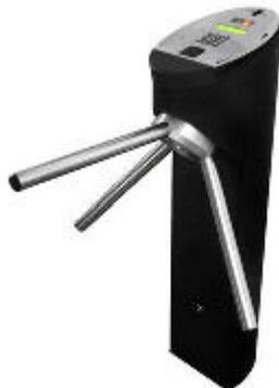
**Utiliza Biometria:** Marque essa opção se a catraca for do tipo biométrico. Para saber se a catraca é biométrica verificar na tampa da catraca se existe o leitor biométrico instalado. Não é preciso configurar no TopPortaria se o tipo da catraca é do modelo Light ou Bio, pois isto é feito automaticamente, basta apenas selecionar a opção “**Utiliza Biometria**” .
