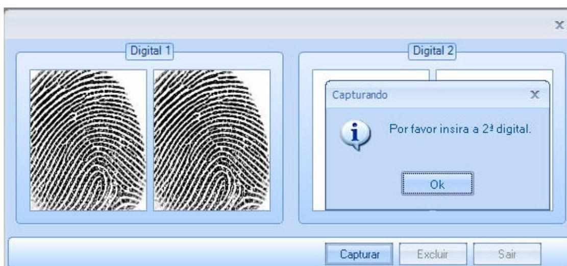
Pronto, a digital está cadastrada. Envie-a para a Catraca. Quando cadastrada ou alterada a digital de uma pessoa, o operador tem a opção de enviar as novas informações biométricas automaticamente. Porém, se a catraca não estiver conectada, esta ação só ocorrerá quando for estabelecida a comunicação on-line com o equipamento.
